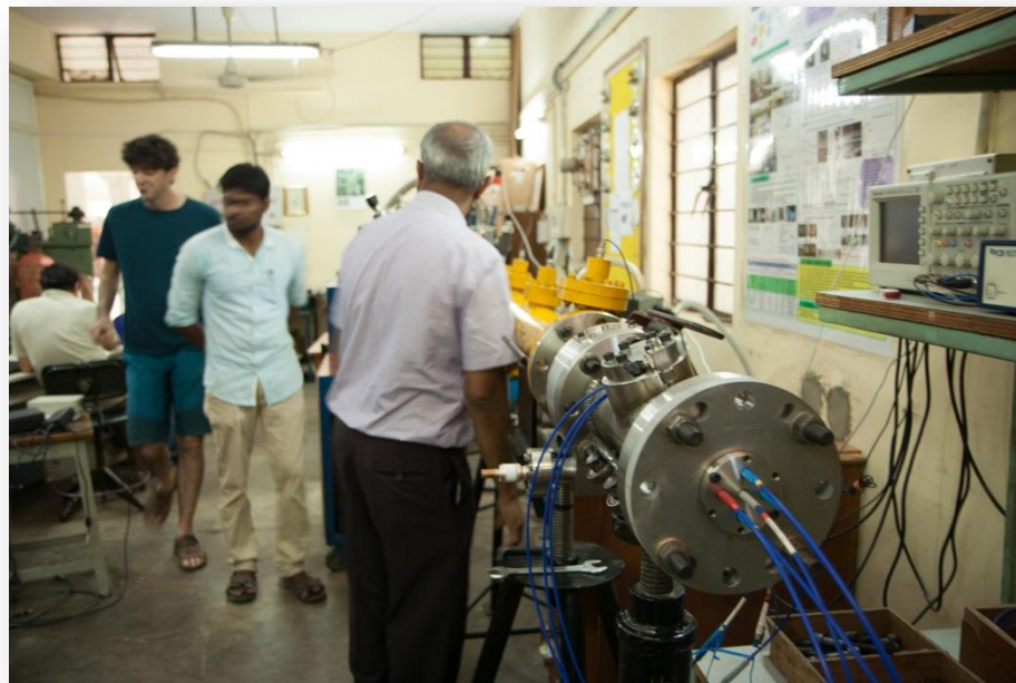
Installation tube à choc IISc Bangalore ( T_{max} \sim 8000 K pendant 3 ms)
